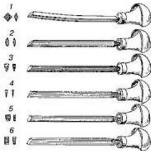
Рис. 228. Образцы форм стихелей для торцовой гравюры: сверху вниз: 1, 2 — грабштихели; 3, 4 — тонштихели; 5, 6 — болштихели
